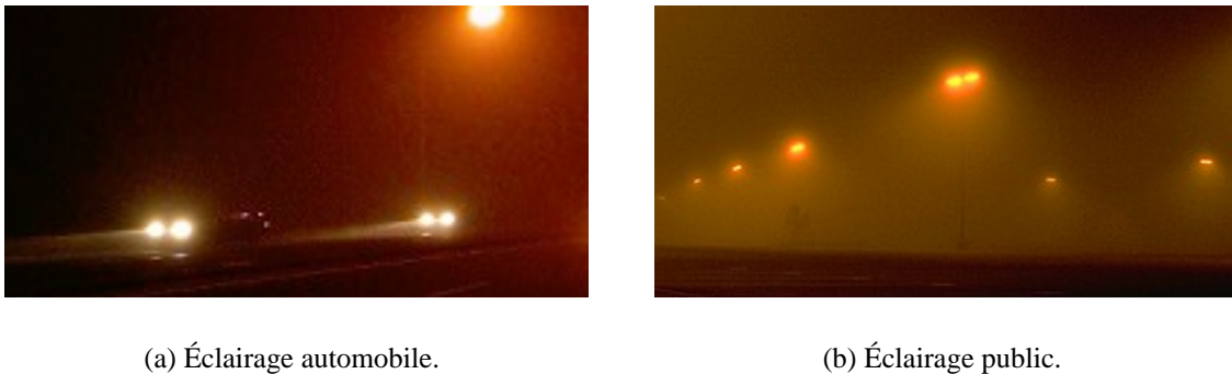
FIG. 6.6 – Exemples de matérialisation du solide photométrique des sources lumineuses dans le brouillard.
