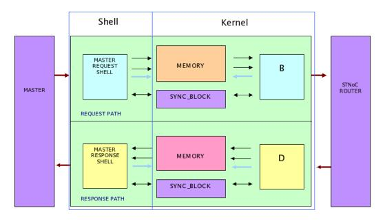
Fig. 2.8: Modèle de microarchitecture d'une interface réseau
