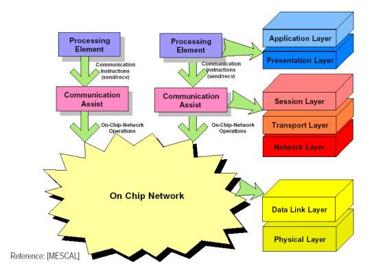
Fig. 2.3: Structuration de la communication pour les futures systèmes sur puce
