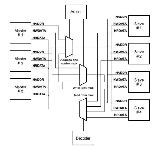
Fig. 2.1: Un exemple d'architecture de bus [2] (ARM AHB).
