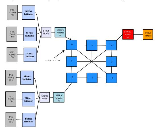
Fig. 2.13: Architecture de l'expérimentation menée sur STNoC<sup>™</sup>
