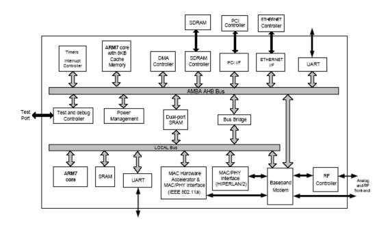
Fig. 2.2: Un exemple d'architecture de bus multi-couche
