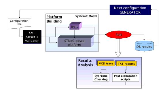
Fig. 2.10: Environnement d'exploration d'architecture pour STNoC<sup>™</sup>
