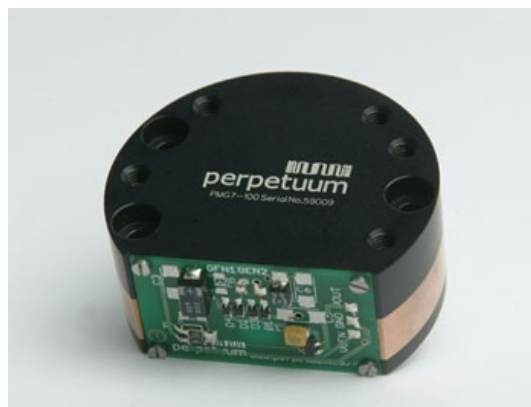
Figure II.23 : Générateur électromagnétique PMG7 de la société Perpetuum.
