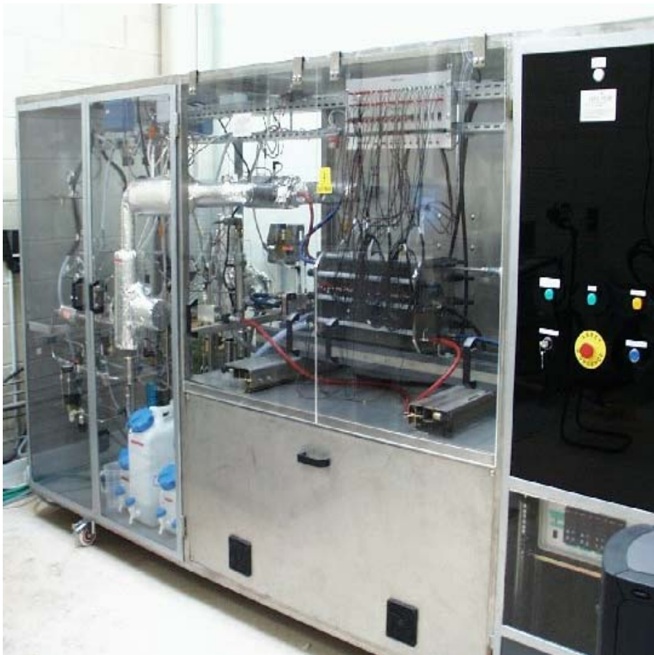
Figure IV- 25 : Photographie du banc Helion 10kW et de la pile 5kW
