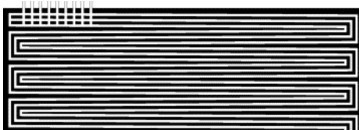
Figure I- 3 : Exemple de plaque bipolaire à canaux, côté air [Sch06a]
