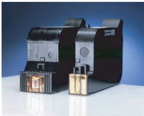
FIG. 5 – Cartouches d'imprimantes à jet d'encre avec leur buse d'impression
