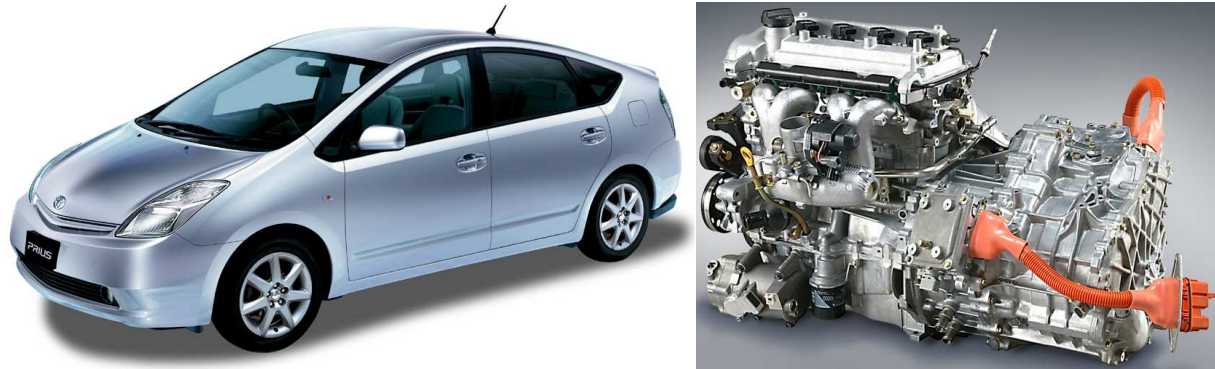
Figure 1.31. Toyota Prius 2 et son système motopropulseur « Toyota Synergy Drive® »
