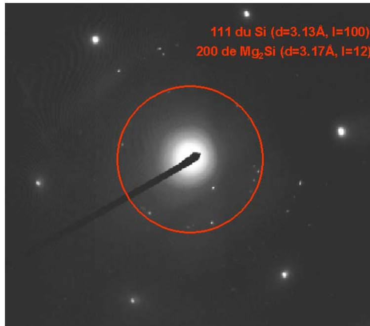
Fig. III.29 – Identification du cliché de diffraction d'un précipité sphéroïdal incohérent avec la matrice.
