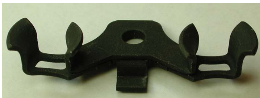
Fig. B.6 – Solution technique apportée aux problèmes de rupture par fatigue thermomécanique : insert métallique faisant office de crack stopper. Après usinage de la face feu, il ne reste que les quatre bords relevés insérés entre les sièges de soupapes, dans les pontets.
