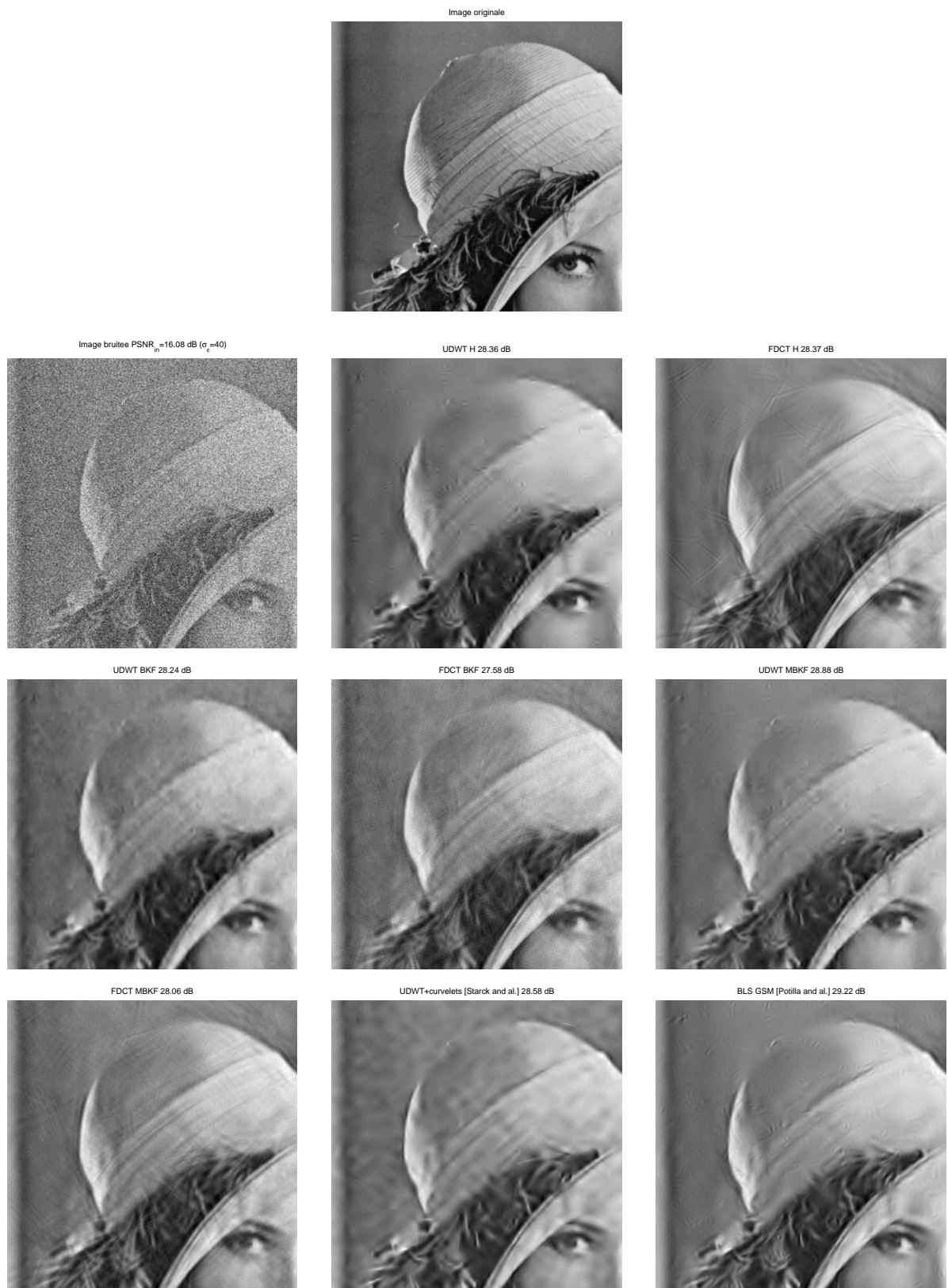
FIG. 6.2 – Comparaison des différents débruiteurs sur l'image test de Lena zoomée sur une région texturée du chapeau. Le zoom montre que la qualité visuelle des débruiteurs avec la FDCT est meilleure à ceux avec l'UDWT.
