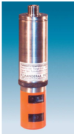
FIGURE 7.2.2: Photographie d'un turbidimètre, d'après Mylvaganam & Jakobsen (1998).
