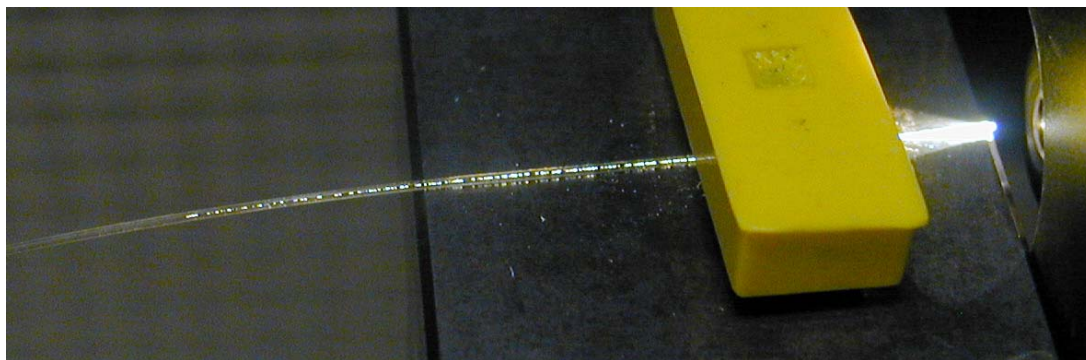
FIG. 1.16 – Dommages optiques répartis sur une dizaine de centimètres dans le coeur signal.
