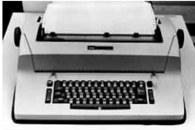
Figure 30 : L'IBM 2741 est une Selectric Typewriter posée sur un meuble plein d'électronique et de câbles. Elle communiquait à 134,5 bits par seconde, en semi duplex. Quand c'était à l'ordinateur de transmettre, il verrouillait le clavier. L'élément d'impression ressemblait à une balle de golf. ( http://www.columbia.edu/acis/history/2741.html , janvier 2001)
