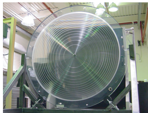
FIG. 2.3 – ( gauche ) Système optique diffractif constitué de deux lentilles de Fresnel ; ( droite ) Prototype de lentille ( 1\text{ m} de diamètre) [48]
