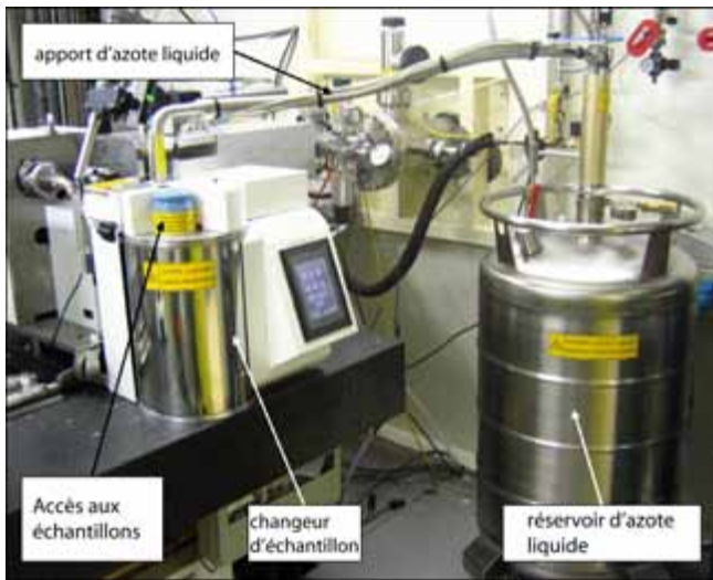
(a) Vue d'ensemble de la ligne de lumière avec changeur d'échantillon
