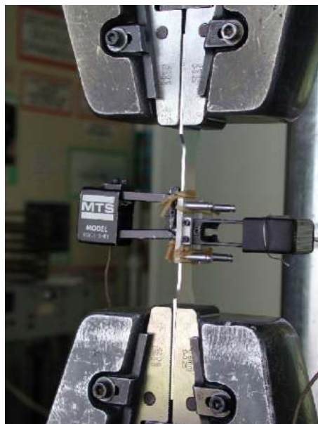
Figure 2.3: Montage pour les essais de traction
