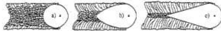
Figure 2.5: Influence de la vitesse sur la macrostructure de la ZF sous une puissance de laser continue de 3.6 kW [64]. (a) 2 m/min., (b) 6 m/min. et (c) 10 m/min.
