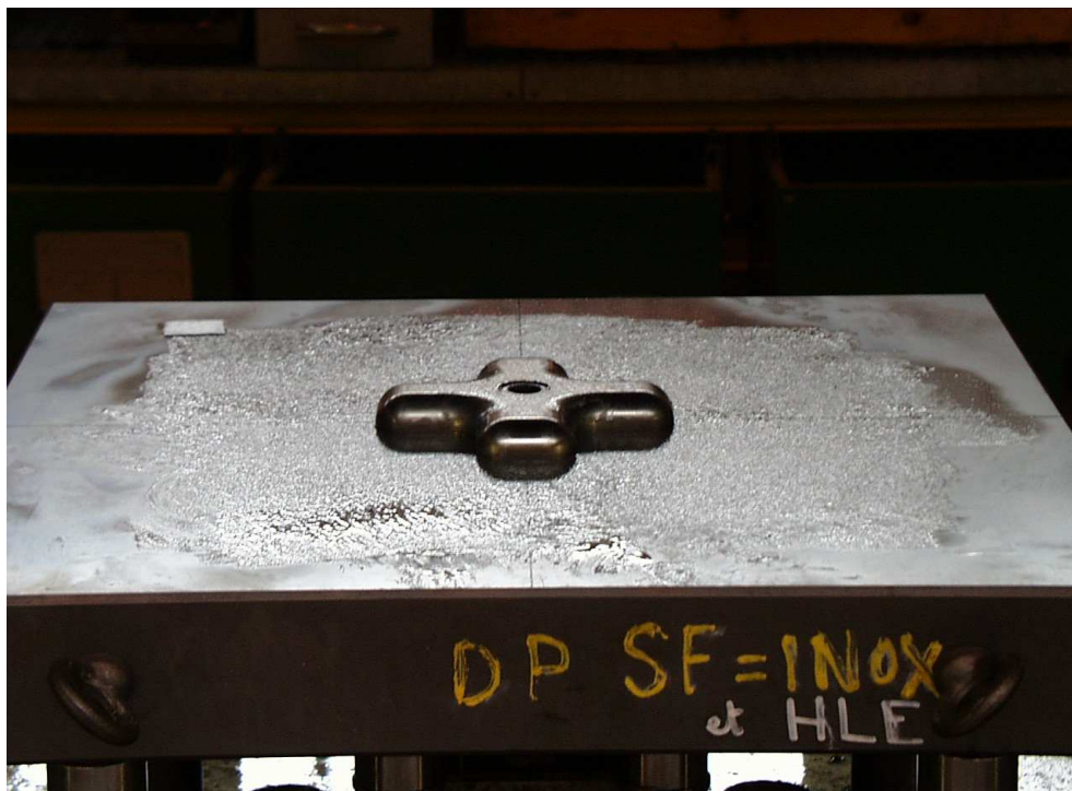
FIG. 145 – Photo montrant le poinçon et le serre-flan de l'outillage utilisé pour réaliser l'essai d'emboutissage en croix. On observe que, contrairement à la région de la partie plate du poinçon, dont le centre est creux, les régions correspondant aux rayons de courbure sont dépourvues de lubrifiant après l'essai
