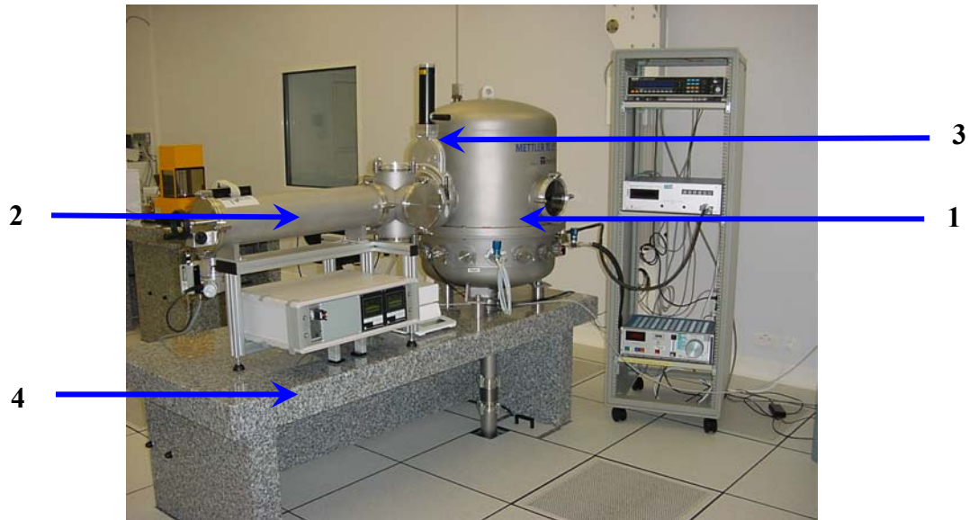
Figure II.10. : Enceinte du comparateur et son sas de transfert en salle propre au LNE
