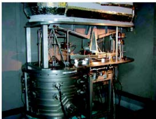
Figure I.13. Photo de l'expérience de balance du watt du NPL [Eichenberger2003]
