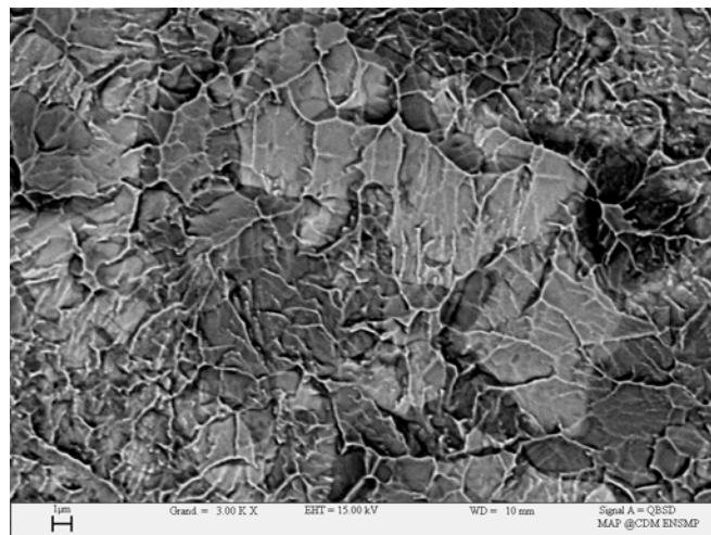
Figure III.17. : Au-Pt12. Traitement isotherme à 500°C pendant 2 heures 30 minutes
