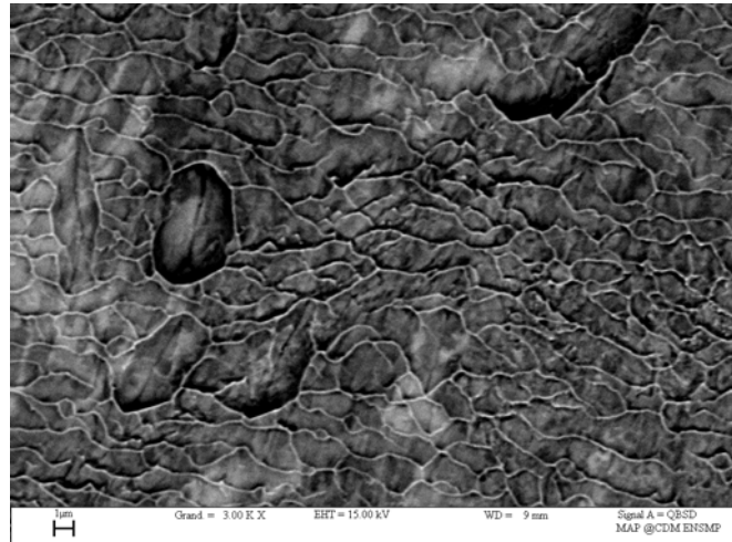
Figure III.16. : Au-Pt12. Traitement isotherme à 500°C pendant 1 heure
