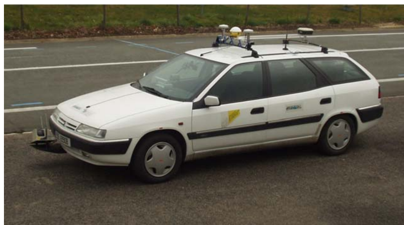
Figure 3.26 le véhicule expérimental avec les antennes Thales et AG132
