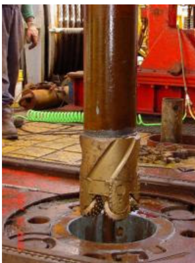
Première tête de forage utilisée lors de la campagne. © 2003-2006 IODP-USIO
