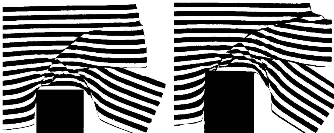
figure I.3 Modélisation de la collision Inde - Asie par le poinçonnement d'un bloc rigide dans une zone plastique homogène déformable (D'après Peltzer et Tapponnier, 1988)
