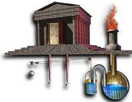
Figure A.2 – Système d'ouverture d'un temple imaginé par Héron
