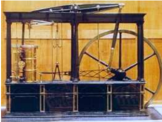
Figure A.4 – La machine de Watt, musée des arts et métiers
