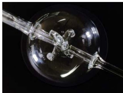
Figure 2-4 : Réacteur auto agité par jets gazeux.
