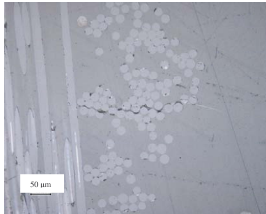
Figure 2. 8 – Observation d'une fissure transverse sur la tranche d'une éprouvette de tissu (sens trame)
