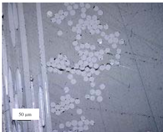
Figure 3. 17 – Fissuration transverse dans les torons de chaîne.
