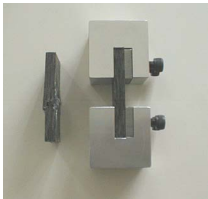
Figure 3. 5 – Eprouvettes de TWINTEX pour les essais de compression (avec et sans talons)
