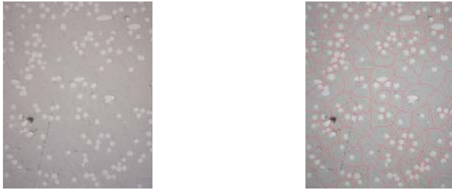
Figure A1.7 – Analyse d'image permettant de déterminer la distance inter-fibres
