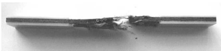
Figure 4. 8 – Eprouvette T de TWINTEX après essai de traction à 100 \text{ s}^{-1} : observation du délaminage
