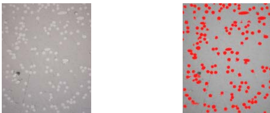
Figure A1. 6 – Analyse d'image permettant de déterminer la fraction volumique de fibres
