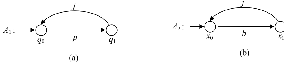
Fig. 1.3. Modèles automates d'un distributeur de jeton
