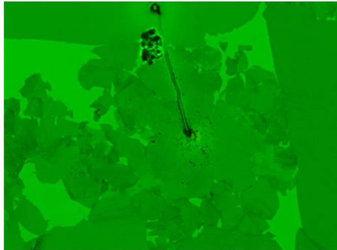
**Figure 46 : Endommagement par le faisceau laser d'un film de nanoparticules d'or fonctionnalisées par des thioalkanes à 12 carbones déposées à l'interface air/eau. La température de la sous-phase d'eau pure est de 15 °C. Les dimensions de l'image prise avec une camera CCD sont 321  $\mu\text{m}$  \* 240  $\mu\text{m}$ .**
