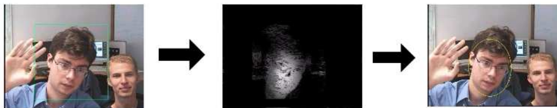
FIG. 2.6 – De gauche à droite : RDI d'un visage dans l'image, Calcul de la carte de probabilité avec fenêtre gaussienne dans la RDI, Ellipse délimitant le visage dans l'image.
