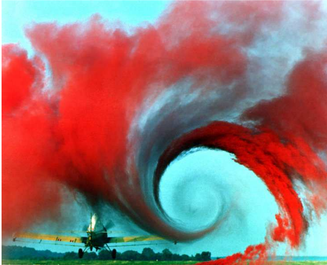
Tourbillon de sillage visible à des gaz colorés disséminé derrière l'avion. NASA Langley Research Center (NASA-LaRC)
