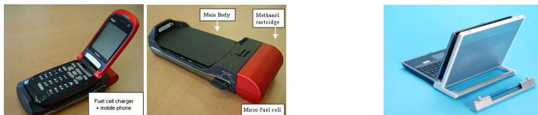
NTT DoCoMo (pour 2006), Spécifications : taille :  $152 \times 57 \times 16 \text{ mm}$  , poids : 190 g, Méthanol : 18 cc, 30%, sortie: 5,4 V , 700 mA,  $50 \text{ mW/cm}^2$ .
