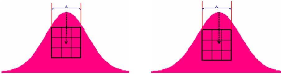
FIG. 6.2 – Schéma explicatif de l'effet de la parabole. Quand le barycentre de la gerbe coïncide avec le centre de la cellule, on a un maximum d'énergie dans le cluster.
