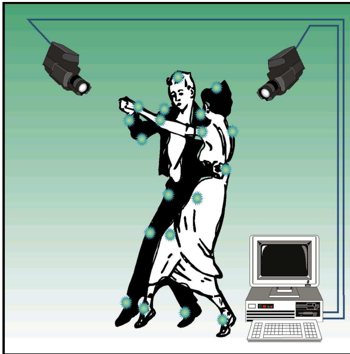
FIG. 11. Principe de fonctionnement des systèmes optiques
