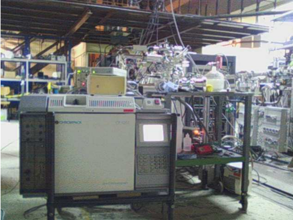
Figure B-3 : Photographie du chromatographe en ligne sur la cellule d'irradiation
