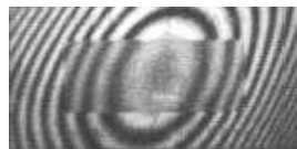
FIG. 4.11 – Interférogramme obtenu par interférométrie de Fizeau pour mesurer la planéité de la face supérieure du réseau de période 210 nm de la configuration 300/210 nm.
