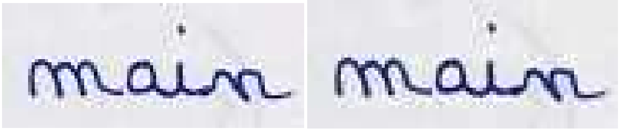
FIG. 2.11 – Robustesse au stockage : A gauche, l'image originale ; à droite, l'image comprimée par la méthode JPEG à 50%
