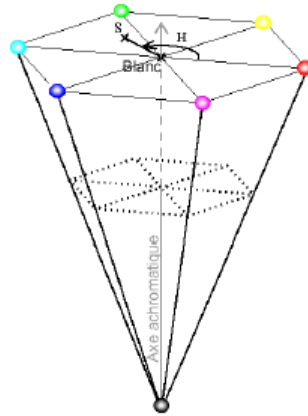
Figure 3.5 – Cône hexagonal représentant les valeurs de teinte, saturation et luminosité de l'espace HSV ; l'axe achromatique représente les différents niveaux de gris (valeur de luminosité) avec des valeurs de saturation nulles et des valeurs de teinte non calculables ; l'éloignement de l'axe achromatique représente la valeur de saturation (maximale sur le bord du cône) ; la valeur angulaire autour de l'axe achromatique représente la valeur de teinte (à une constante près).
