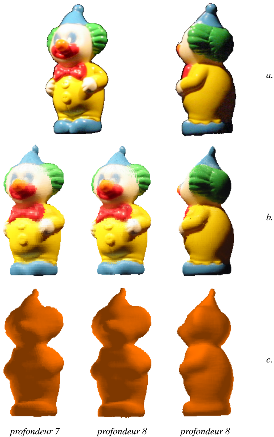
Figure 2.46 – Une série de 72 images de résolution 256 \times 256 est utilisée pour la reconstruction de cet objet réel (l'acquisition de ces images a été effectuée avec une méthode d'étalonnage moins précise que celle présentée dans ce manuscrit) ; a. photographies d'un clown en plastique d'aspect spéculaire ; b. rendu du maillage sans rééclairage : l'utilisation de la luminance moyenne émise par chaque voxel réduit les effets spéculaires visibles sur les photographies ; c. rendu diffus du maillage.
