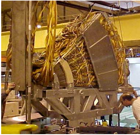
Figure 33: Photographie d'un module bouchon en cours d'insertion dans son cryostat de test sur la ligne de faisceau H6 du SPS.
