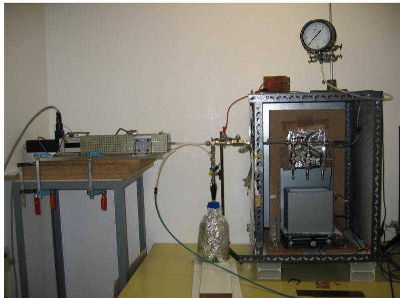
FIG. 4.3 – Photographie du dispositif de mesure ECT du LEA, pousse-seringue à gauche, bouteille d'huile au centre et cage de Faraday (ouverte) à droite.
