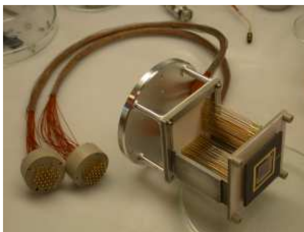
FIG. 3.17: Ensemble de porte-échantillon utilisant une connectique mixte.
