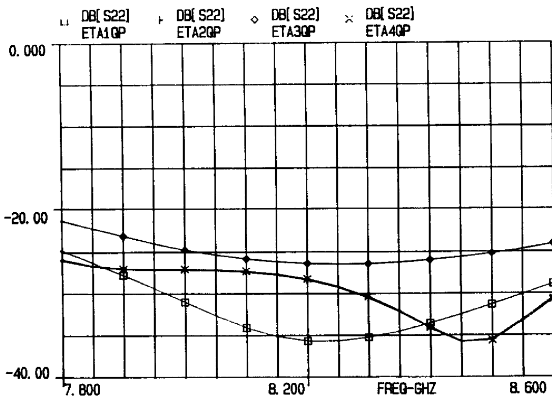
figure 4.25 : S22 simulées des 4 états du modulateur OPSK HP07
