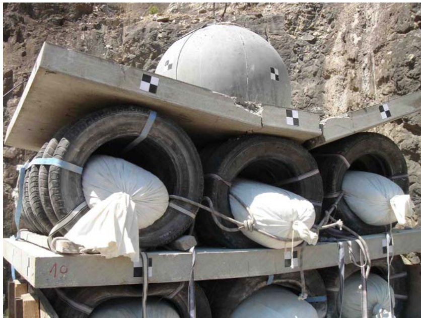
Figure III 34 : Vue de face de la structure sandwich après un impact à 90 kJ (14m)
