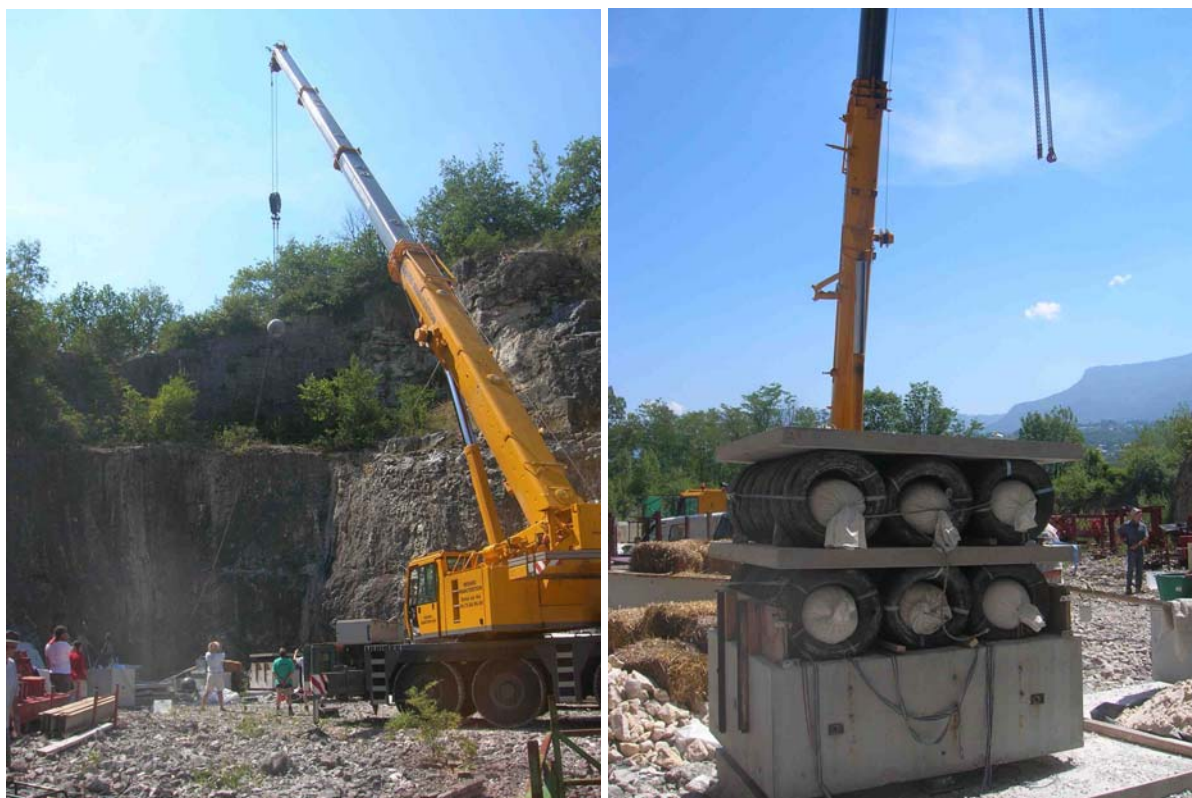
Figure II 21 : Campagne V : essai à 100 kJ, structure double sandwich
