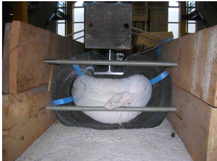
Figure III 11 : Dispositif d'essais de compression simple sur colonne de pneus
