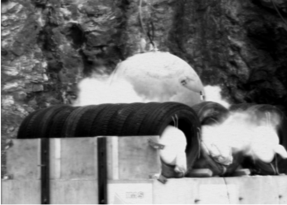
Figure III 6 : Essai d'impact direct sur les colonnes de pneus (ouvrage 2)
