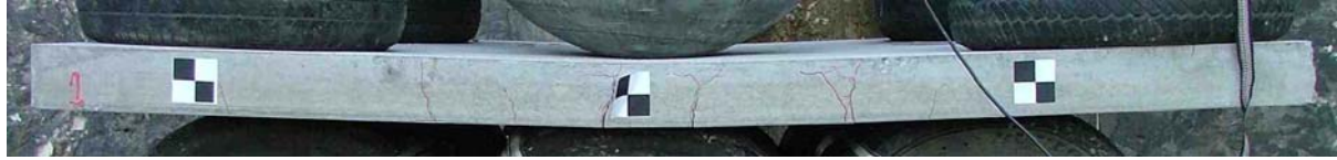
Figure III 25 : Fissures de traction pour un essai d'impact à 13 kJ
