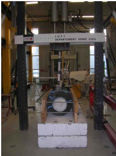
Figure III 11 : Dispositif d'essais de compression simple sur colonne de pneus
