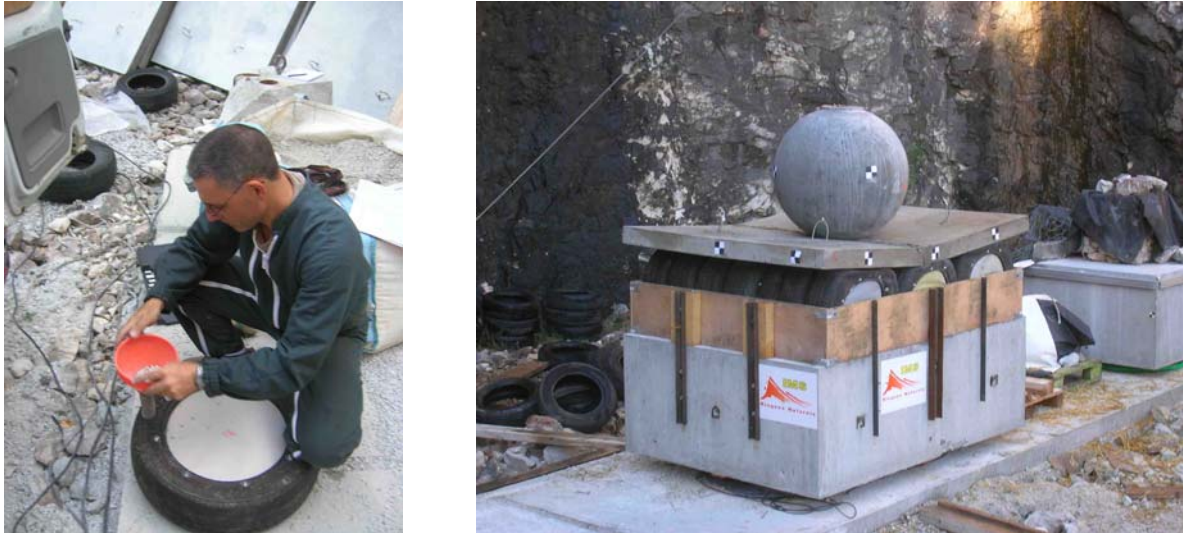
Figure III 8 : Technique de remplissage du pneu de voiture, Structure impactée
