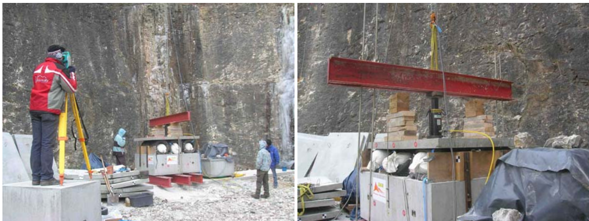
Figure III 13 : Dispositif d'essai de compression simple sur la structure sandwich
