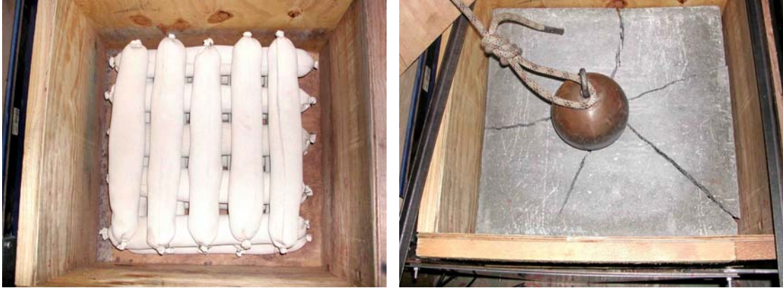
Figure II 7 : Vue de dessus des 4 couches de géotextiles remplis par du sable, dalle béton impactée
