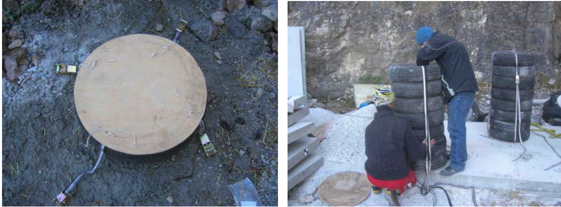
Figure III 1 : Vue de dessous sur le disque en bois et les 4 sangles prises entre le pneu et le disque, assemblage des pneus de la colonne
