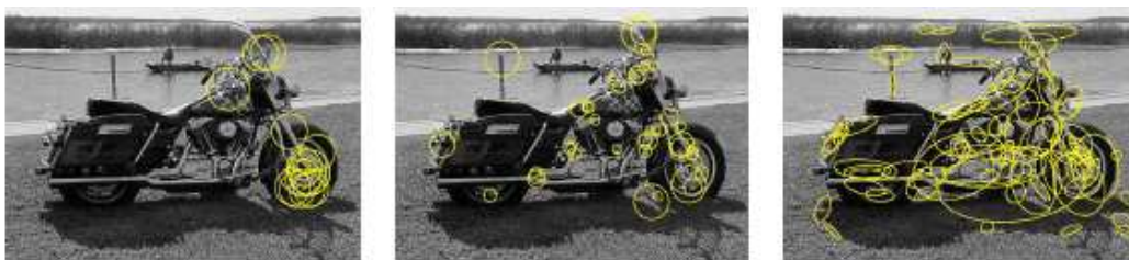
FIG. 1.16 – De gauche à droite : Quelques points d'intérêt détectés par le détecteur de Kadir et Brady, le détecteur Harris-Laplacien, le détecteur Harris-Laplacien-Affine.
