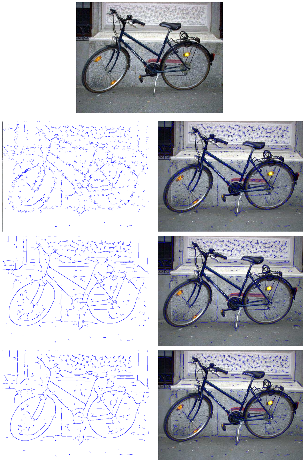
FIG. 2.24 – Crêtes détectées à l'échelle \sigma = 4\sqrt{2} par trois mesures : la courbure de la courbe de niveau \kappa , la courbure principale \lambda_1 et le Laplacien Lap .
