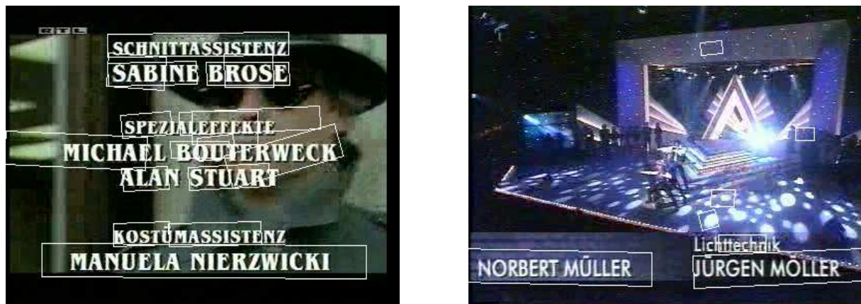
FIG. 4.12 – Détection de textes en séquences vidéo. Il y a très peu de fausses détections. La localisation n'est pas parfaite : Le rectangle encadrant une région de texte peut être plus grand que la région elle-même.
