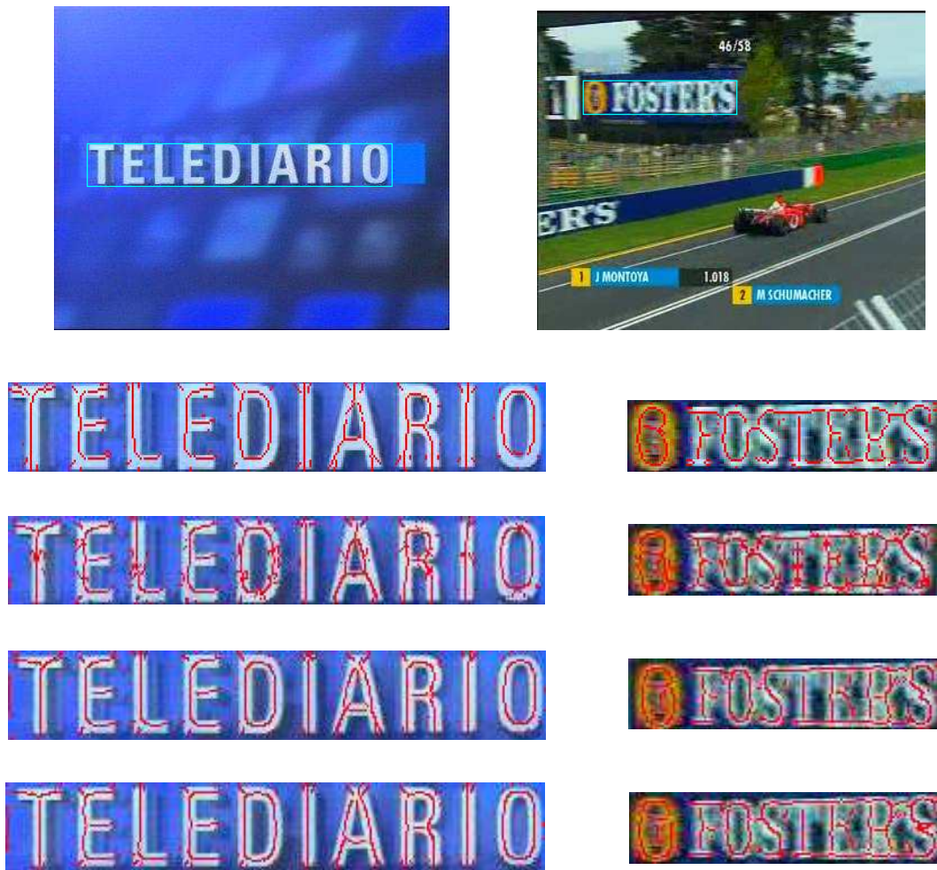
FIG. 2.18 – De haut en bas, l'image originale du texte, le résultat de détection à l'échelle \sigma = 4 (avec le texte "TELEDIARIO") et l'échelle \sigma = 2 (avec le texte "FOSTER'S") en utilisant 4 mesures : le Gaussien, la courbure de la courbe de niveau, la courbure principale, le Laplacien.
