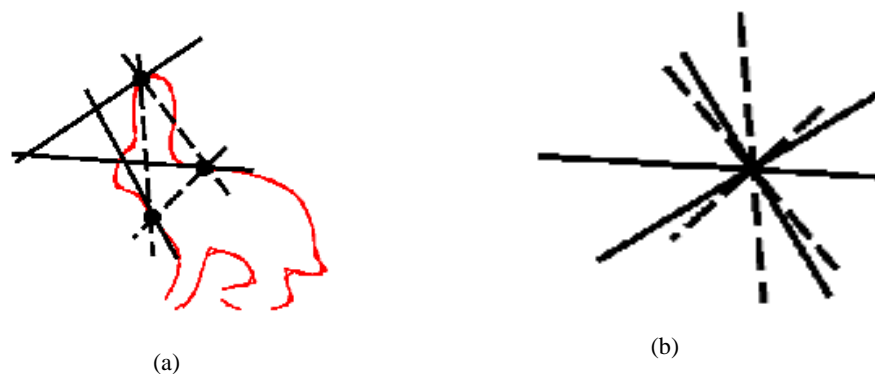
FIG. 1.18 – Calcul de OrderType [TC04]. (a) Point sur le contour de l'objet. Chaque order type est calculé sur un triplet de points aléatoires sur le contour. (b) 6 segments créés de 3 points constituent un order type.
