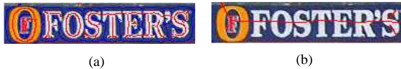
FIG. 4.2 – Superposition des crêtes détectées à l'échelle \sigma = 4 et \sigma = 16 sur l'image originale : (a) à l'échelle \sigma = 4 , les crêtes courtes correspondent aux traits des caractères. (b) à l'échelle \sigma = 16 , une crête longue horizontale représente la ligne de texte.
