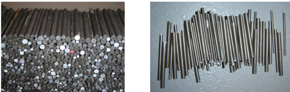
Figure 26 – Photographies des rouleaux de Schneebeli
