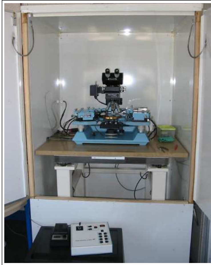
Figure 3.5: Photographie de la cage de Faraday conçue pour le banc de mesures bas bruit.
