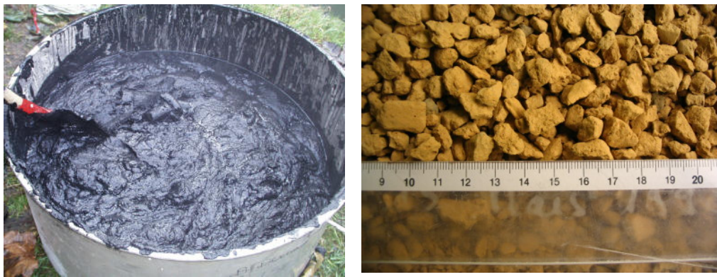
Figure 60. Le sédiment 17000 avant (photo de gauche) et après traitement par le procédé Novosol® (photos B. Clément)
