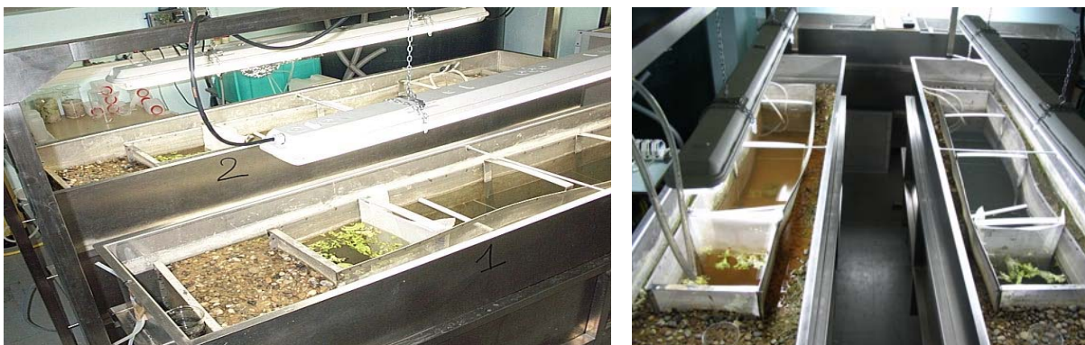
Figure 5. Dispositif d'alimentation en continu des gravières
