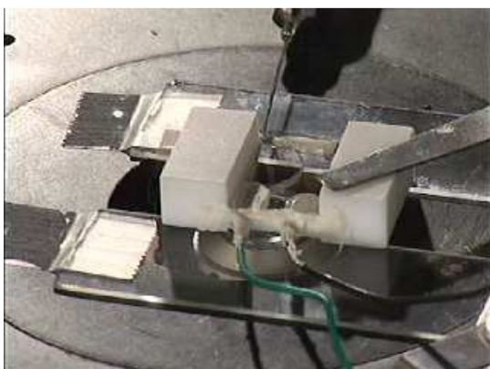
Figure 2_3: Injection d'une solution aqueuse de sucrose dans la chambre d'électroformation en partie scellée.
