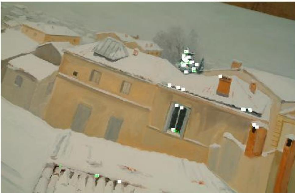
Figure 4.17 - Mise en correspondance des deux images Calvet1 et Calvet2 avec normalisation de la couleur: (les bons appariements sont représentés par des pavés blancs, les mauvais par des croix vertes. Le taux de bons appariements est de 65%).
