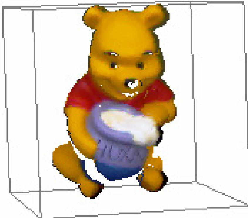
Figure 5.13 - Recalage fin des nuages 3D/couleur Ours1 et Ours2 par la transformation estimée par ICPGCTYIQ.
