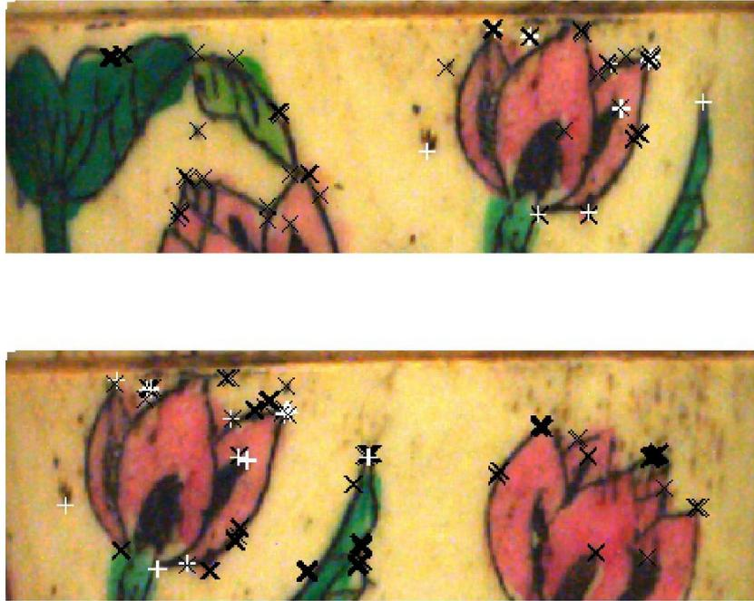
Figure 4.19 - Mise en correspondance des deux images Calvet1 et Calvet2Ivoire avec normalisation de la couleur diamètre 25 (: les bons appariements sont représentés par des croix blanches, les mauvais par des croix noires. Le taux de bons appariements est de 18%).
