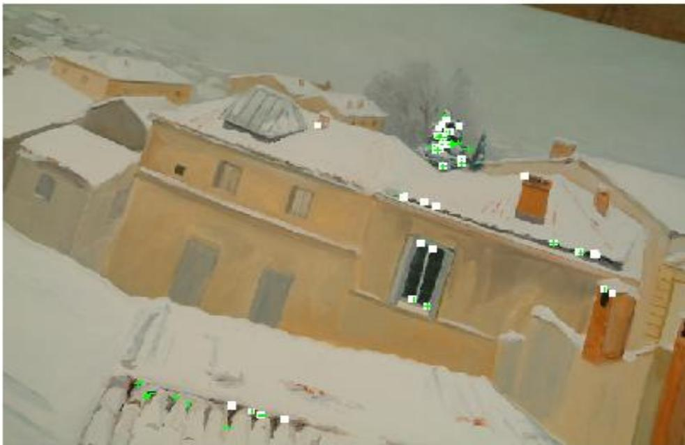
Figure 4.16 - Mise en correspondance des deux images Calvet1 et Calvet2 sans normalisation de la couleur (: les bons appariements corrects sont représentés par des pavés blancs, les mauvais par des croix vertes. Le taux de bons appariements est de 43%).
