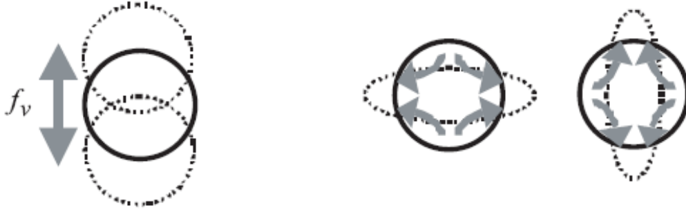
FIG. 1.8 - Schéma illustrant les 2 types d'oscillation de la charge en lévitation. A gauche : oscillation globale verticale ; à droite : oscillation naturelle de mode 2.
