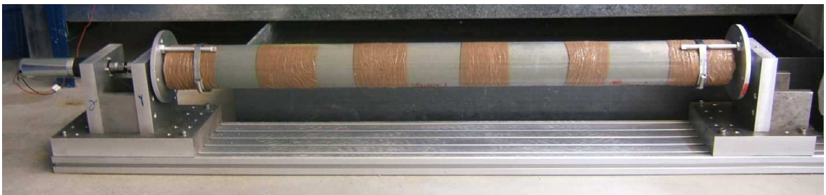
FIG. 2.13: Colonne de sable injecté montée sur le "dispositif rotatif"
