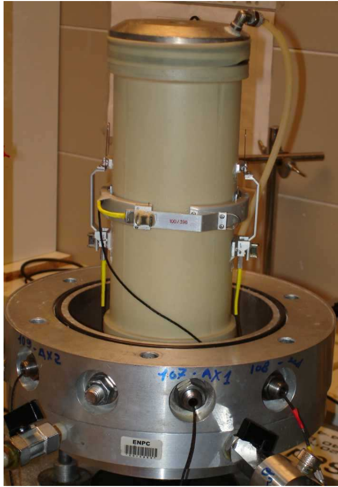
FIG. 2.24: Vue d'une éprouvette de sable injecté équipée des capteurs à effet Hall et placée sur la base de la cellule triaxiale
