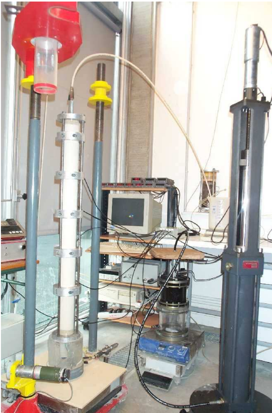
FIG. 2.1: Dispositif d'injection de colonne
