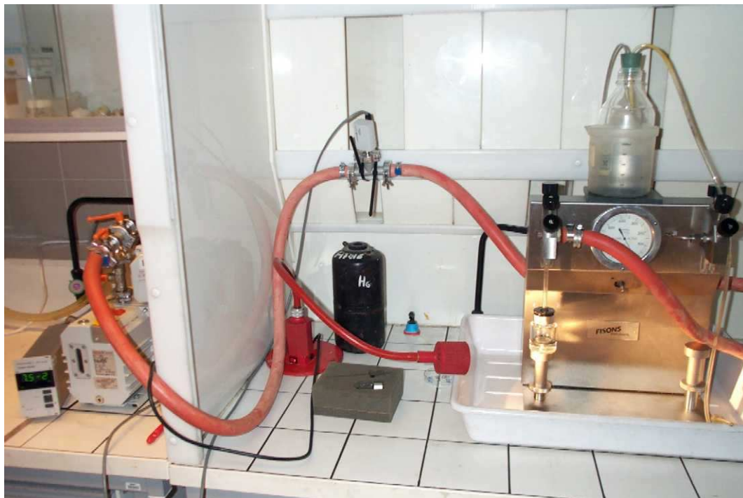
FIG. 2.29: Vue du dispositif de remplissage du dilatomètre au mercure
