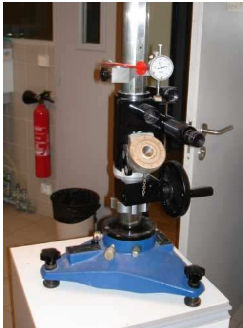
FIG. 2.30: Dispositif optique pour la lecture du niveau de mercure
