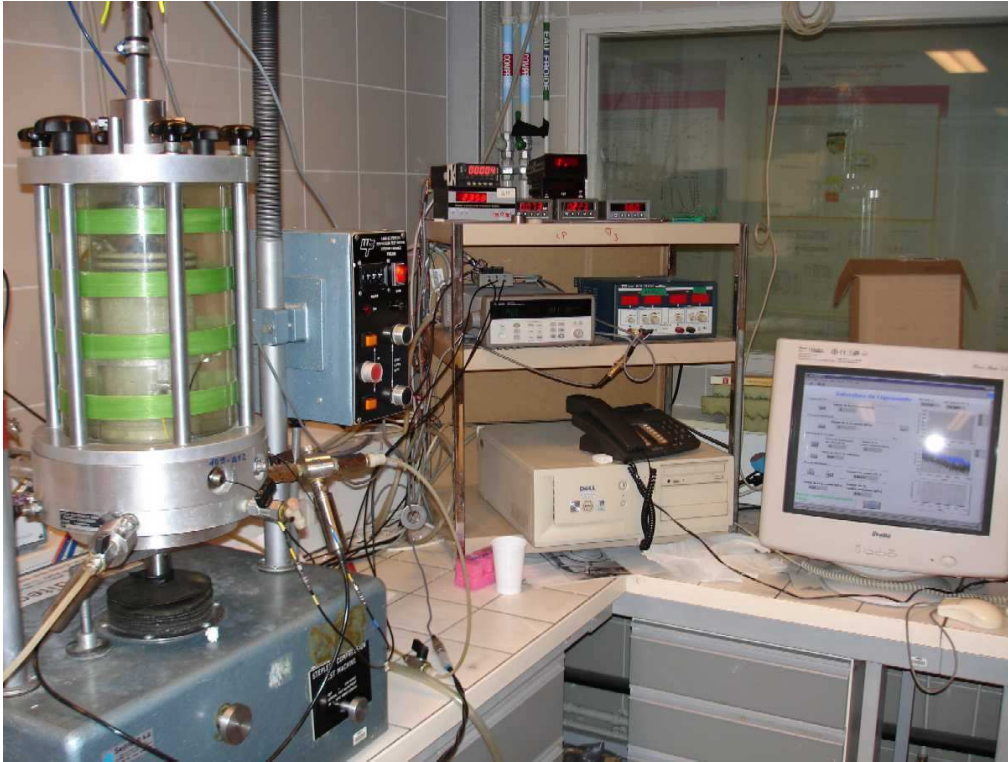
FIG. 2.17: Vue du poste de travail de l'essai triaxial
