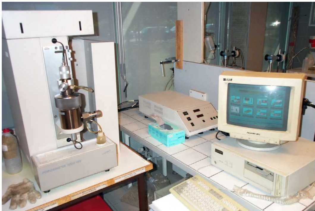
FIG. 2.33: Vue du porosimètre à intrusion de mercure et du système d'acquisition correspondant
