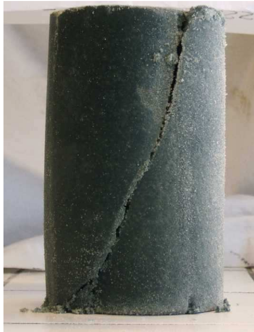
FIG. 3.12: Éprouvette de sable injecté après un essai triaxial : illustration du plan de rupture
