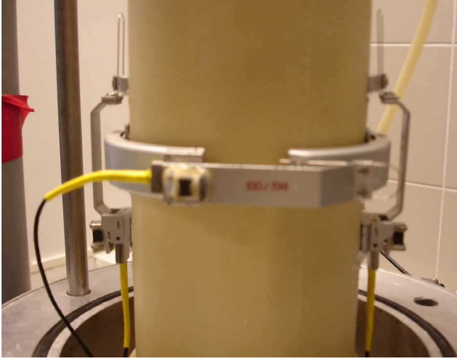
FIG. 2.21: Fixation des capteurs axiaux et radial du système de mesure locale
