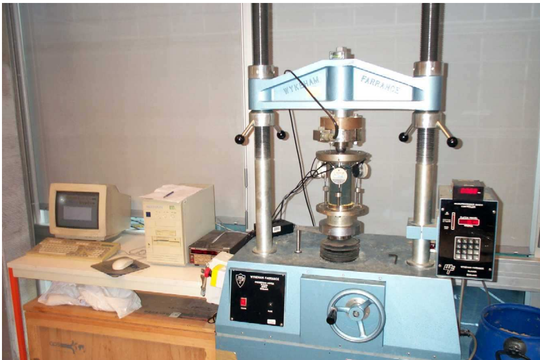
FIG. 2.15: Vue du dispositif de compression uniaxiale
