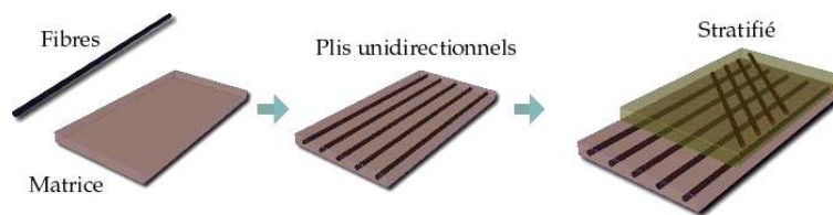
Figure 5.1 – Constitution du composite stratifié à fibres longues
