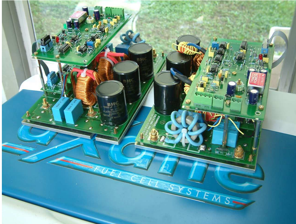
Fig. 2.26. Les deux convertisseurs réalisés
