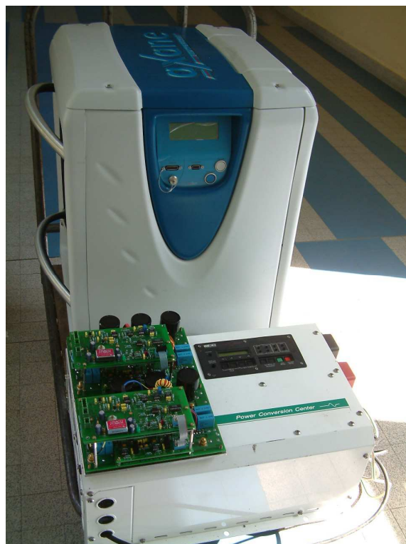
Fig. 2.27. Deux convertisseurs réalisés avec la PAC et l'onduleur fourni avec la PAC
