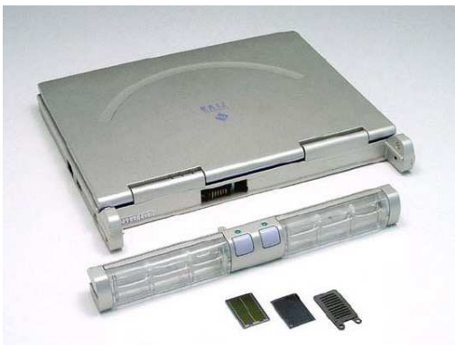
Fig. 1.4. PEMFC de Casio pour ordinateur portable (mars 2002). Autonomie de plus de 24h.
