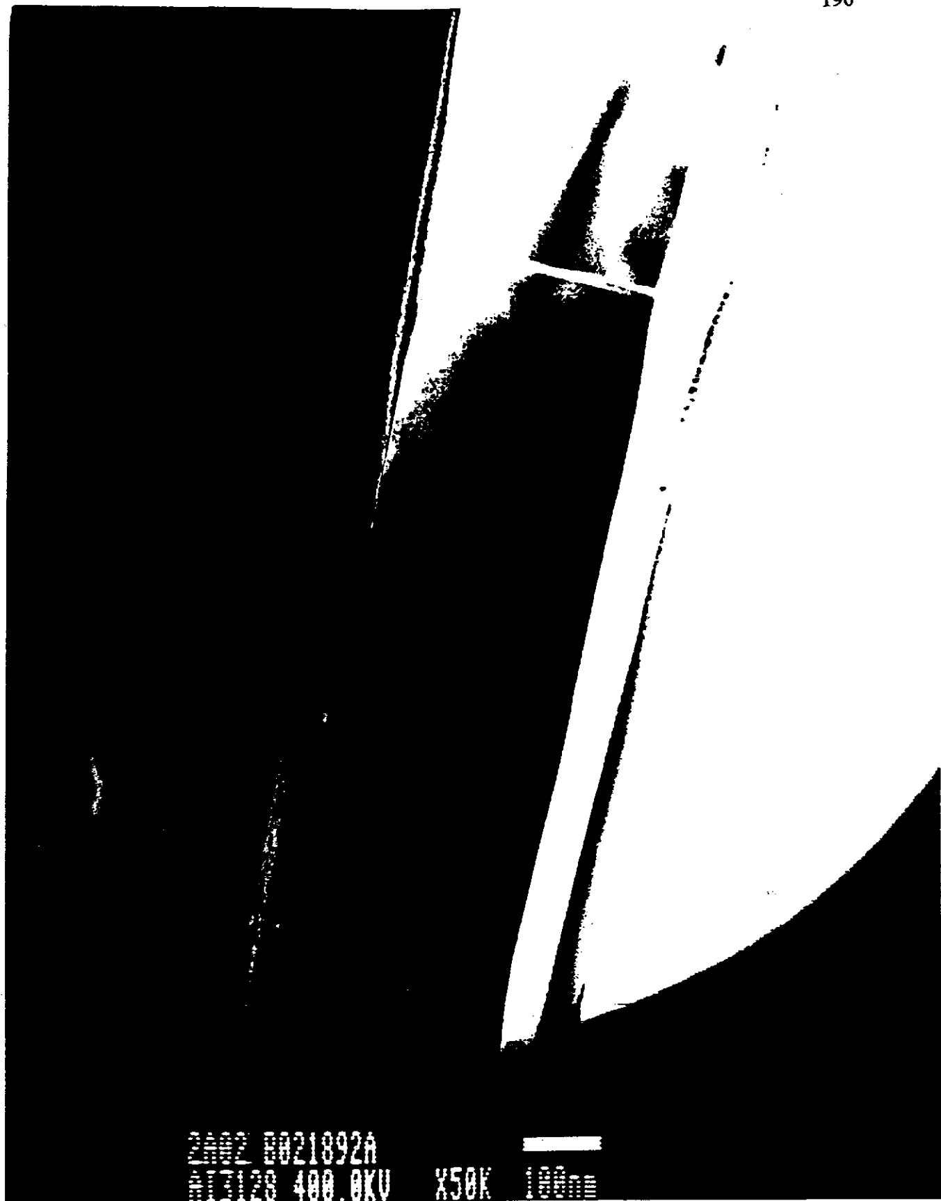
Figure 9 - Image de microscopie électronique par transmission d'une coupe transversale d'un film de BGO (faible grossissement)
