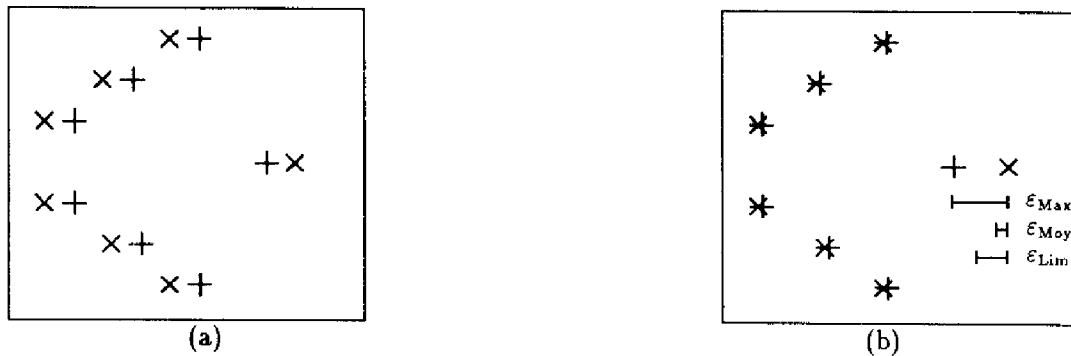
FIG. VII.3 – Principe d'appariement de structure d'objets. Les sommets des objets du modèle global sont représentés par des "x" et ceux des objets du modèle local par des "+". On étudie l'hypothèse qui associe les sommets les plus proches. Figure (a) : avant application de la transformation T_u . Figure (b) : après son application. On remarque que l'erreur maximale \varepsilon_{Max} est plus grande (donc plus sélective) que l'erreur moyenne \varepsilon_{Moy} . En effet, si l'on se réfère à \varepsilon_{Max} et à la valeur limite \varepsilon_{Lim} , cette hypothèse serait rejetée; en revanche pas celle associant les six sommets de gauche.
